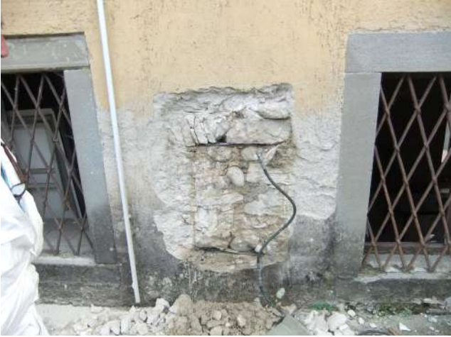
Prova tramite martinetti piatti
