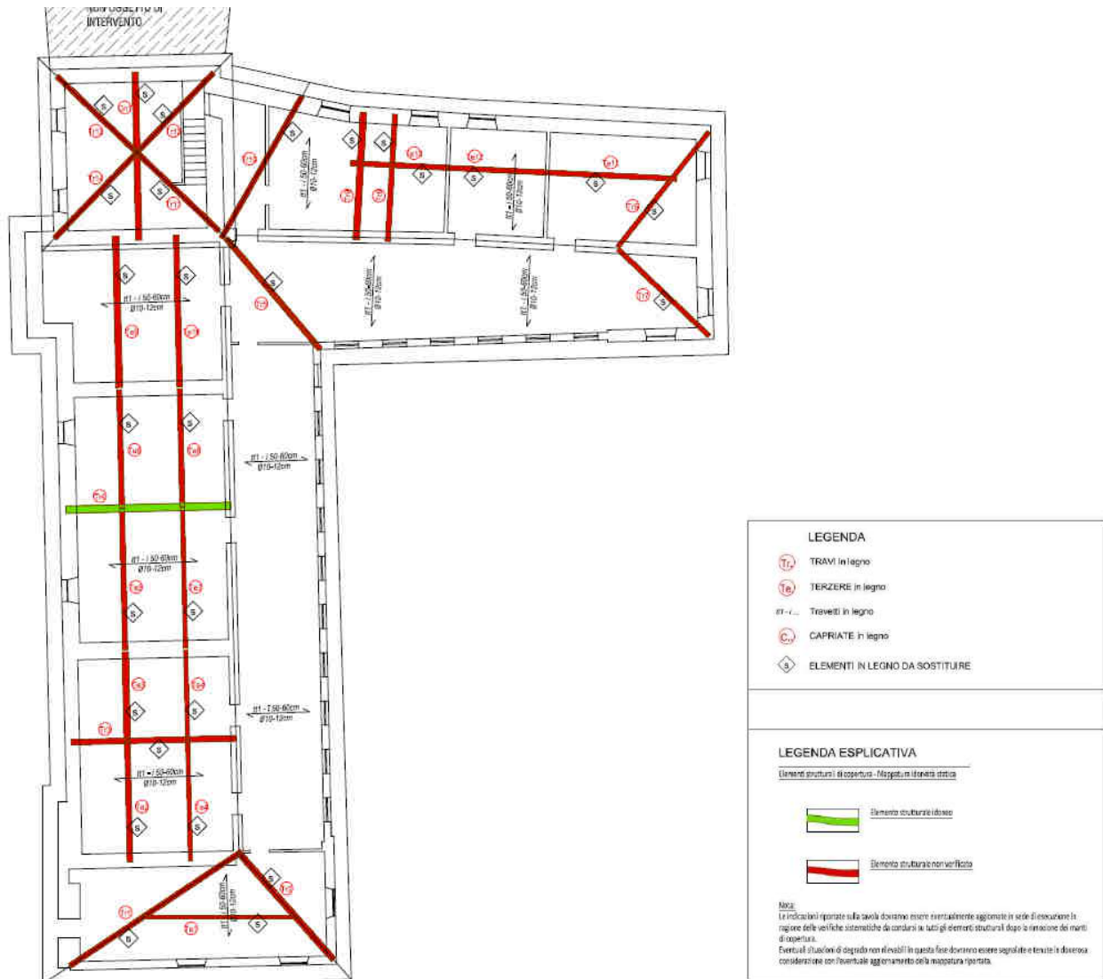
Mappatura orditura in legno della copertura esistente
